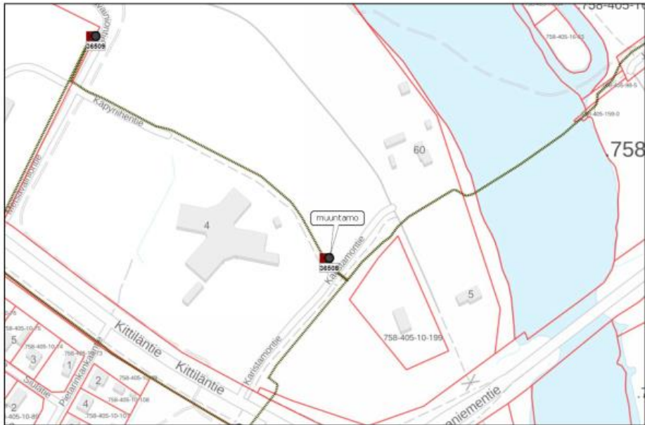
Kuva 16. Nykyinen 20kV jakeluverkko.
