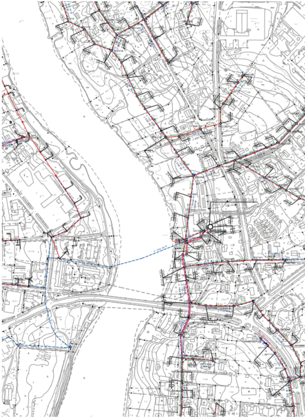
Kuva 12. Vesi- ja viemäriverkosto, sekä kaukolämpöverkosto.
