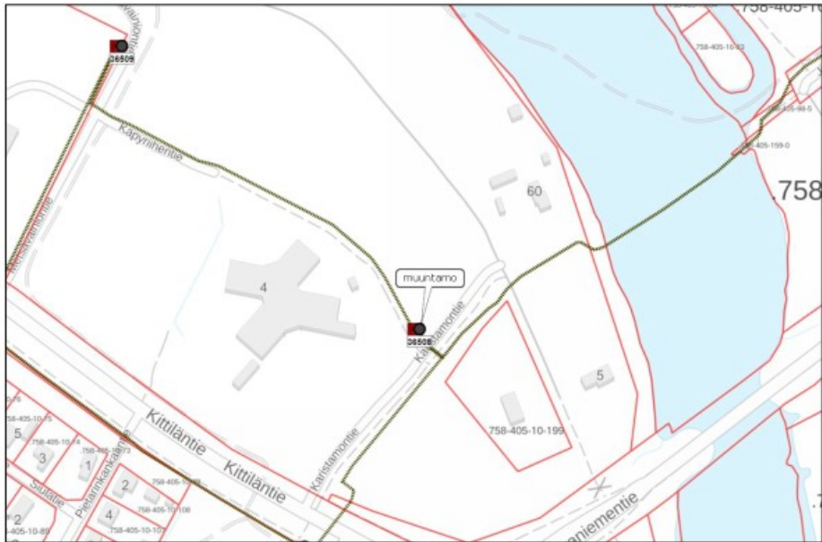
Kuva 14. Nykyinen 20kV jakeluverkko.
